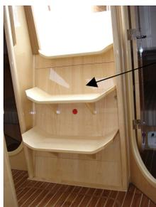
Orifizio per l'ugello dell'estintore nel comparto motore
