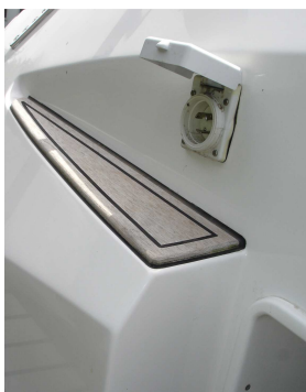
Abnahme am Kai an der hinteren Schürze Backbordseite
