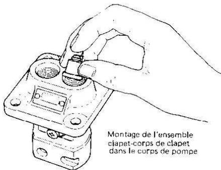
Montage de l'ensemble clapet-corps de clapet dans le corps de pompe
