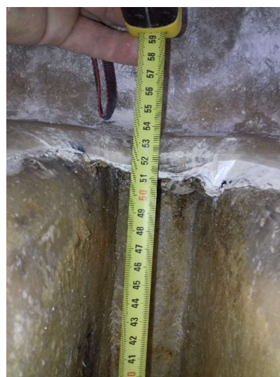
Mousse interne de l'aileron. Quelques traces noires (à droite) 52 cm de profondeur.
