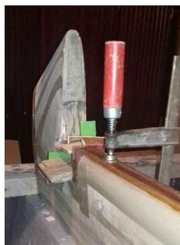
Pour protéger des traces de colle époxy, on utilise du scotch d'emballage (le scotch marron utilisé pour fermer les cartons d'emballage) ainsi que le plastique des sacs poubelle, ou du « film fraîcheur » qui sert en cuisine pour protéger un plat lorsqu'on le met au frigo.
