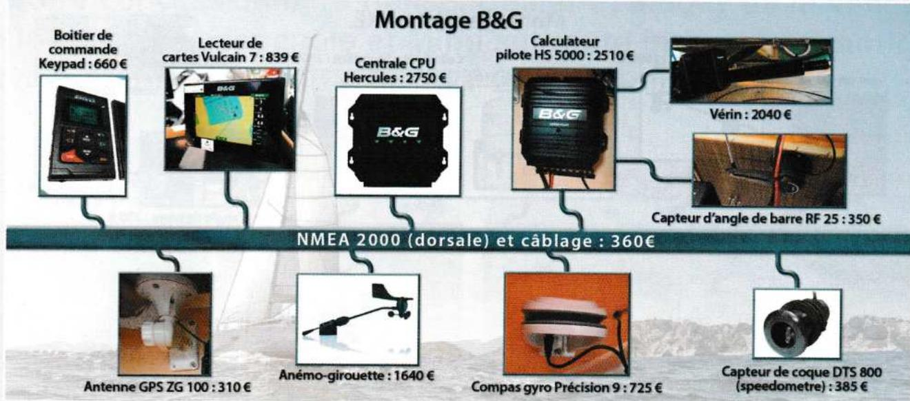
▲ Chez B&G, l'unité de puissance et le gyro-compas sont indépendants du calculateur pilote. Une perte de place pour une meilleure fiabilité?
