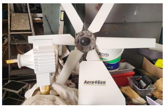
Pour le test, j'ai connecté une perceuse à l'axe de rotation, mis un voltmètre aux bornes et connecté un ventilateur 12 v cc pour avoir de la charge. Tout est ok, Ouf de soulagement après de très nombreuses heures de boulot, mais je pense que ça en valait le coup.
