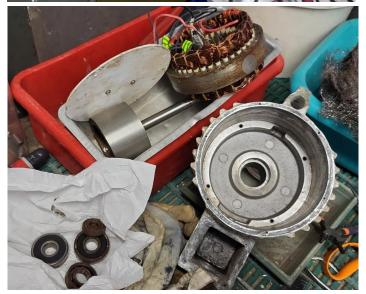
Il faut sortir le stator pour pouvoir extraire l'arbre de rotation et ses 2 roulements. Après inspection, tout parait en bon état, le pont de diode, les condensateurs et les charbons. Seuls les roulements sont HS et bien rouillés. Un bon grattage du corps et des éléments, suivi d'un dégraissage à l'acétone permettra de repeindre le tout avec une peinture spéciale aluminium.
