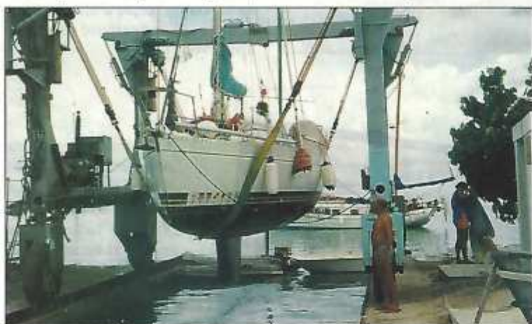
Une sortie régulière du bateau au moment de l'escale permet l'inspection complète de la coque et le remplacement des anodes, la corrosion électrolytique étant redoutable dans les mers chaudes.
