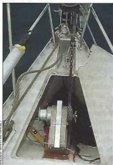
A l'avant du Feeling 10.90, l'indispensable guindeau et un mouillage principal constitué de 40 mètres de chaîne... pour la sécurité.
