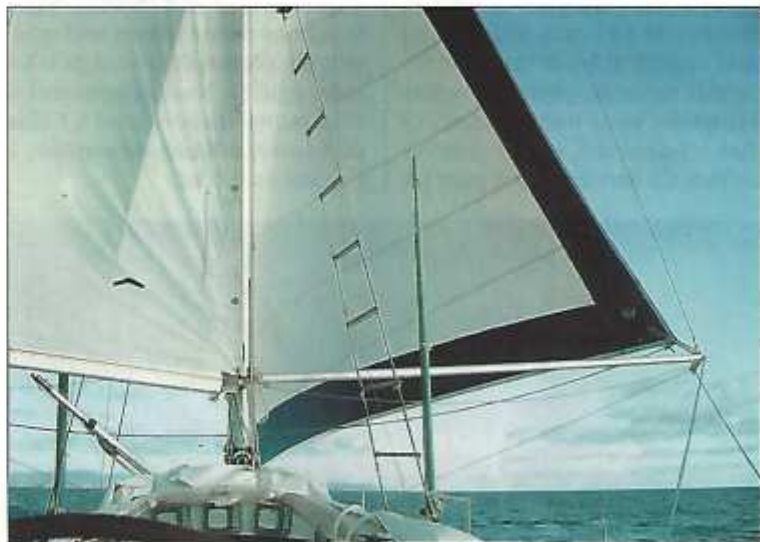
Au vent arrière, lors des grandes traversées, Pierre et Geneviève ont le plus souvent navigué sous grand-voile et génois en ciseaux, ce dernier étant tangonné. Notez l'échelle le long des bas-haubans pour grimper facilement dans le mât.
