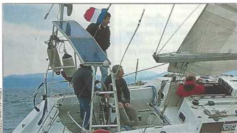
Le portique situé à l'arrière reçoit les panneaux solaires, l'éolienne, ainsi que les antennes radar et GPS.
