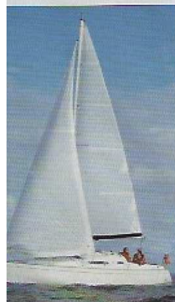
Grâce à un géniois à faible recouvrement, le plan de voilure est très équilibré.
