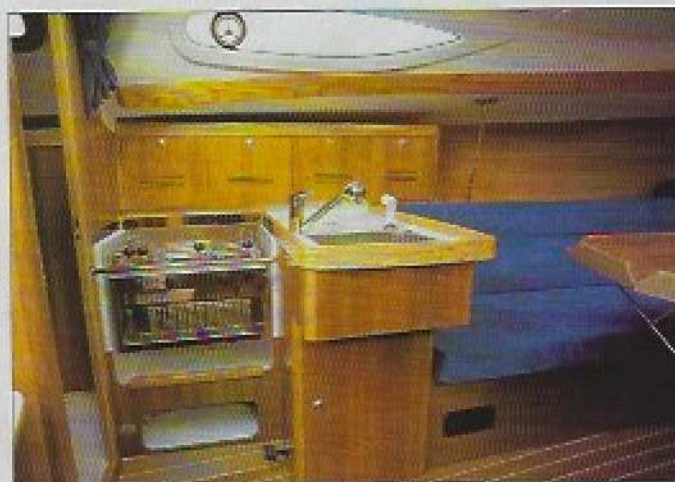
Sous le réchaud deux feux, la gazinière est équipée d'un gril. Notez la petite aération circulaire dans le hublot.
