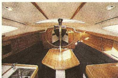
Lumière : avec trois grands hublots, la lumière est remarquable dans le carré qui propose une hauteur sous barrots tout à fait acceptable pour cette taille de bateau : 1,81 m au pied de la descente.
