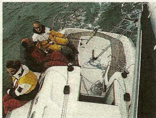
Winches : les deux winches autour de la descente offrent une bonne position, debout, pour régler la tension de drisse.
