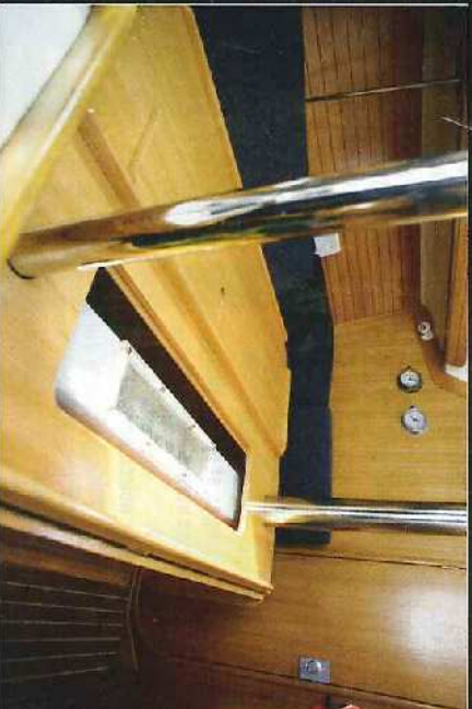
▲ Le puits de dérive est masqué par la table qui dispose d'une plaque au milieu. Elle donne accès à une trappe située sur le haut du puits.
