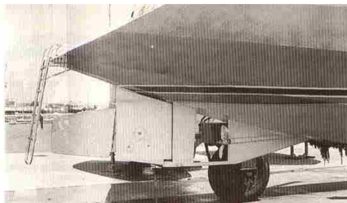
Sur l'Ovni, un aileron fixe protège l'hélice et le safran relevable.
