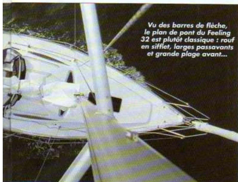
*Vu des barres de flèche, le plan de pont du Feeling 32 est plutôt classique : rouf en sifflet, larges passavants et grande plage avant...*
