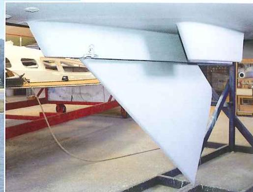
Der Schwenkkiel mit seiner breiten Ballastplatte und den beiden seitlichen, profilierten Stützen erlaubt problemloses Trockenfallen. Der Tiefgang lässt sich von 2,20 Meter auf 70 Zentimeter verringern
