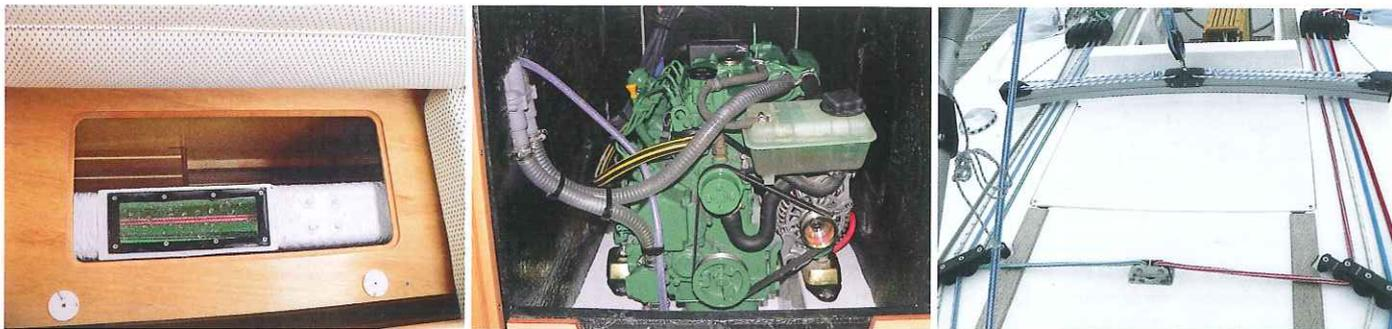
Von links: Unter der Sitzbank des Salons befindet sich der Kasten des Schwenkkiels mit dem Kontrollfenster der Leinenführung. Der Motor ist von allen Seiten bequem zugänglich. Vor dem Traveller die Umlenkung der Leinen des Schwenkkiels zu den Winschen
