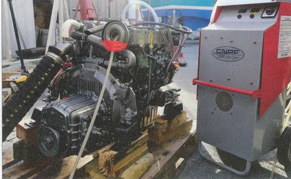
▲ Décalaminage : pendant une heure, l'hydrogène injecté dans le circuit d'air va nettoyer en profondeur le moteur.
