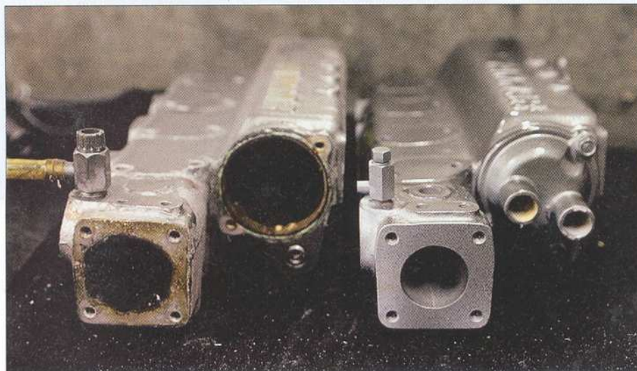
▲ Le collecteur d'échappement d'origine « bouffé » de l'intérieur et son remplaçant sorti d'usine.
