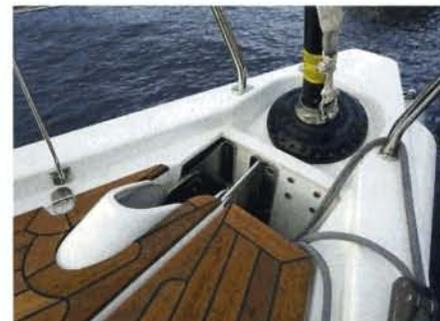
**Versenkt. Die Rollanlage der Selbstwendefock ist in den Bug eingelassen**
