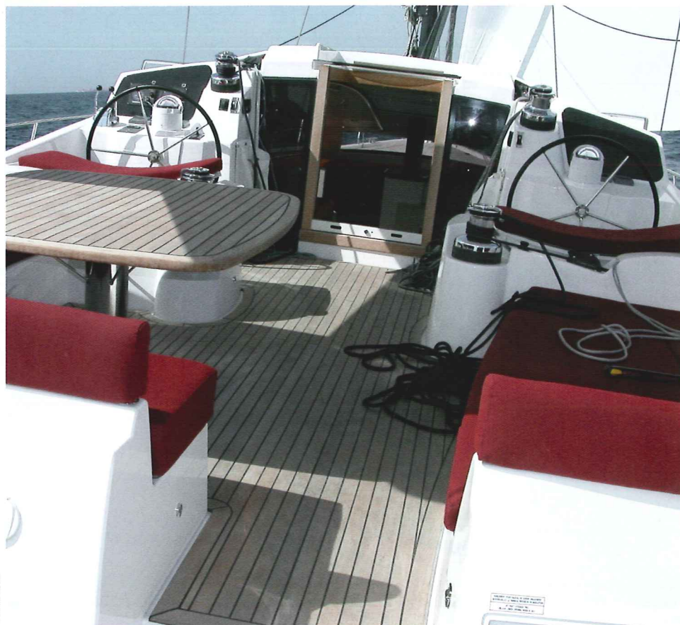
Die Cockpit Aufteilung erinnert stark an die mancher Katamarane mit den Steuerrädern am Achterschott des Kajütaufbaus und den Winschen für Großsegelfall und -schot neben dem breiten Niedergang. Mit den auf hüfthohen Konsolen dahinter platzierten Winschen werden die Vorsegelschoten getrimmt. Den Abschluss bildet der Gästebereich (o.). In der heckbreiten Garage ist Raum für einen Schlauchboottender (u.).
