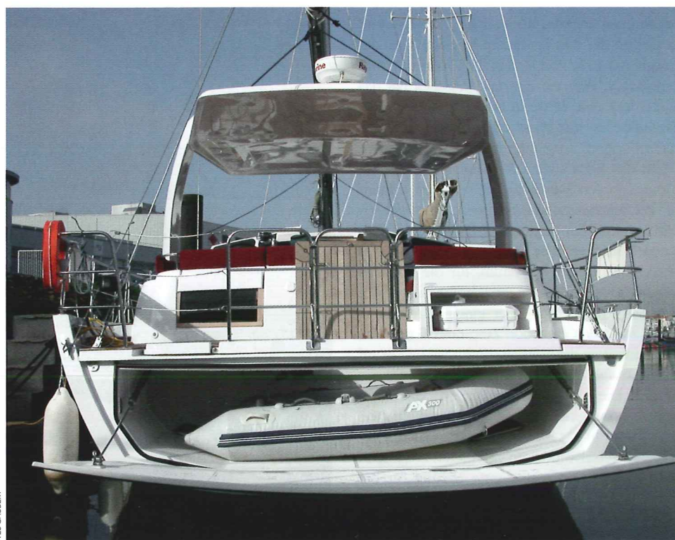
Die Cockpit Aufteilung erinnert stark an die mancher Katamarane mit den Steuerrädern am Achterschott des Kajütaufbaus und den Winschen für Großsegelfall und -schot neben dem breiten Niedergang. Mit den auf hüfthohen Konsolen dahinter platzierten Winschen werden die Vorsegelschoten getrimmt. Den Abschluss bildet der Gästebereich (o.). In der heckbreiten Garage ist Raum für einen Schlauchboottender (u.).
