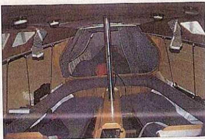
Façon lit breton, la cabine avant est séparée du carré. Le bordé peint en blanc est apparent au niveau des couchettes.
