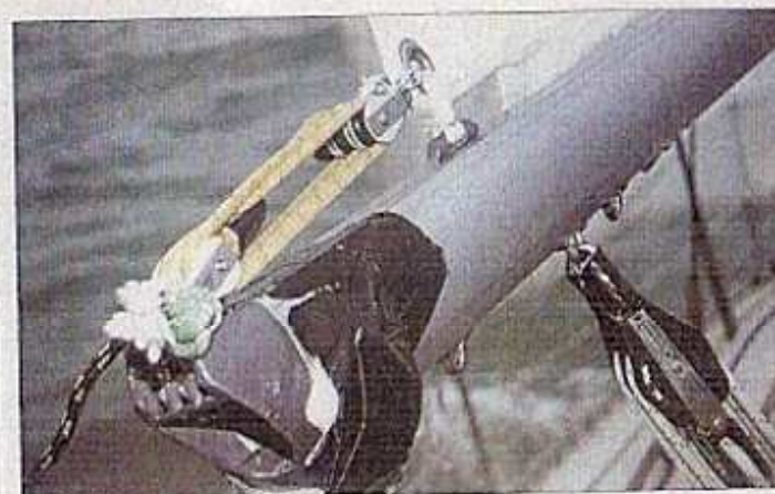
C'est Pierre qui a monté ce palan six brins pour régler au centimètre près la tension de la bordure de grand-voile.
