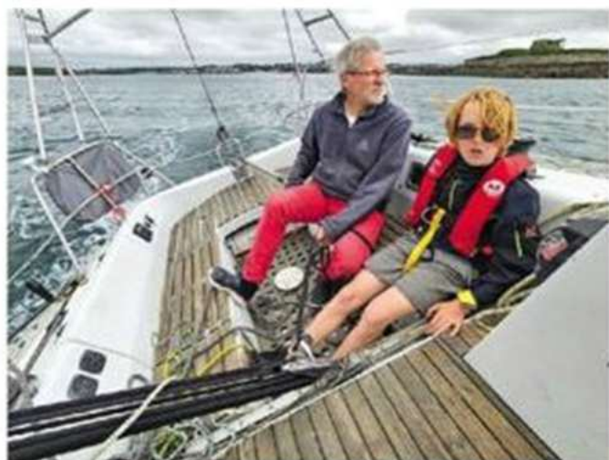
Le cockpit est très joliment habillé de lattes de teck, ajourées, comme cela se faisait, pour garantir une évacuation optimale de l'eau.
