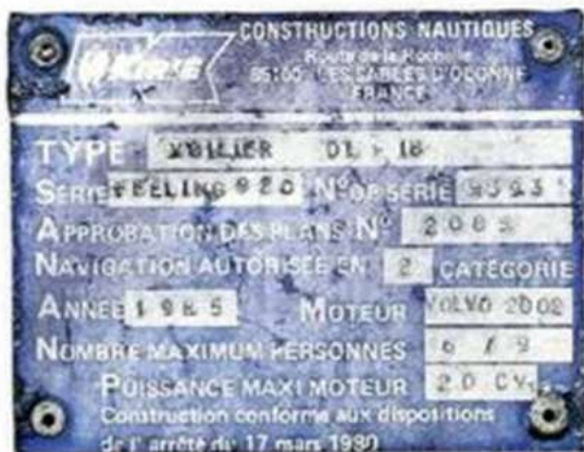
Plaque constructeur de Saga. Il était autorisé à naviguer en deuxième « catégorie de navigation » et donc à s'éloigner jusqu'à 200 milles d'un abri. Aujourd'hui, ces catégories n'ont plus cours.
