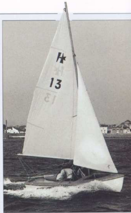
Construit en stratifié de polyester, le Haddock est le premier dériveur léger conçu par Philippe Harlé.
