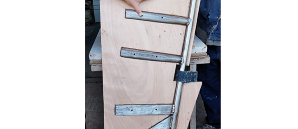
Découverte de l'avarie : la mèche en inox de 32 mm de diamètre s'est rompue en fatigue.
